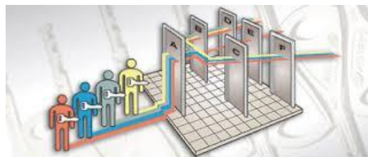
Rys. nr 6. Przykładowe sekwencjonowanie dostępu w systemie klucza głównego (za: mat. inf. ABLOY)
